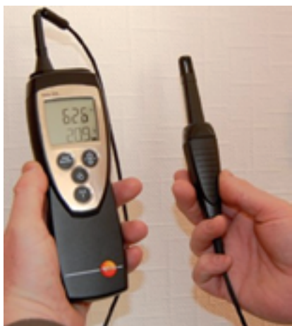
Abb. A1: Messung von relativer Luftfeuchte und Lufttemperatur mithilfe eines Thermo-Hygrometers
